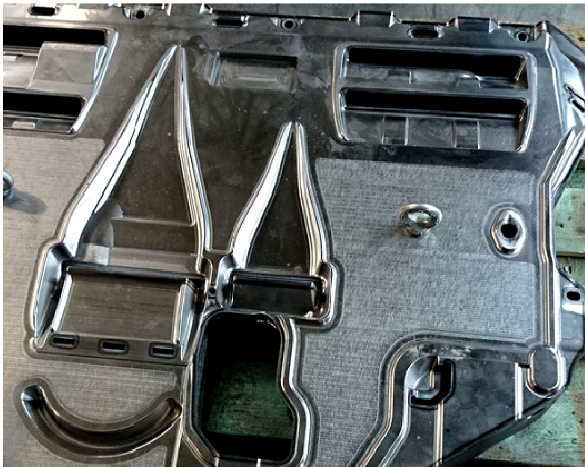
Kalenie rezných hrán vyrezávacieho nástroja v automobilovom priemysle
