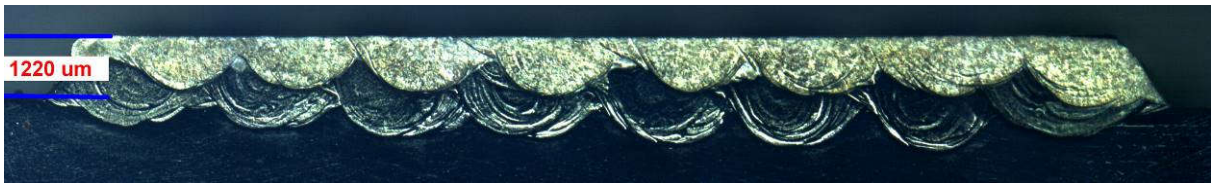
Dvojvrstvé naváranie odlišným materiálom, s meraním hrúbky po obrúsení
